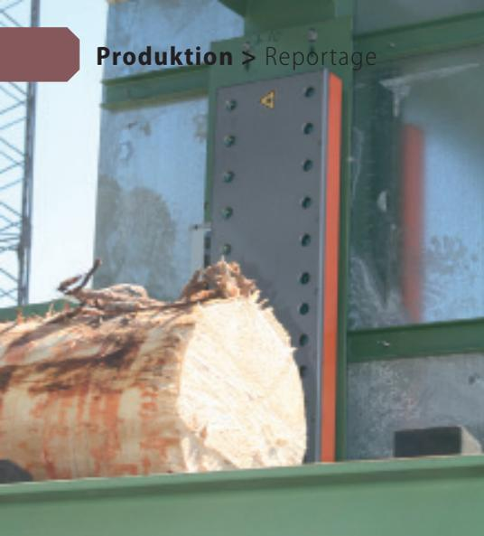
**Einfacher Aufbau:** Ein Infrarotbalken mit Empfänger und zwei Laser-Balken genügen
