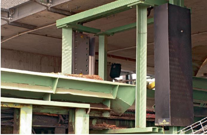
**Hier wird abgerechnet:** 16 Laserpunkte werden auf die Stammoberfläche projiziert – Infrarotkameras messen daraus die Kontur
