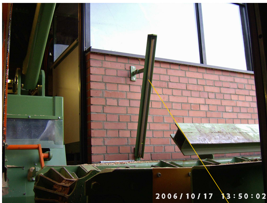
Volumenmessanlage mit einem Abstand der Messholme von 4,00 m
