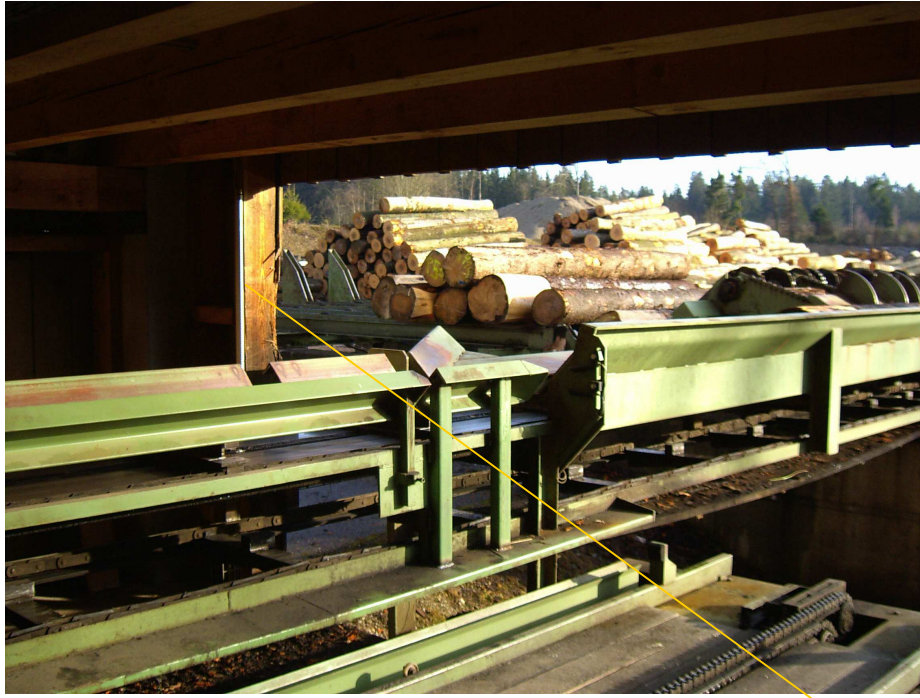
Volumenmessanlage mit einem Abstand der Messholme von 4,00 m
